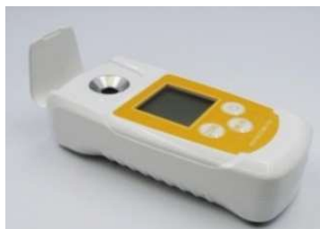
実際の糖度 (破壊式糖度計)
